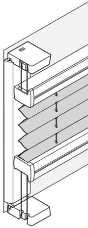
Montage des Systems direkt auf das Glas, ganz ohne Bohren und Schrauben. Die Halteleisten werden auf die Fensterscheibe geklebt, danach werden die Halterungen aufgesteckt.
